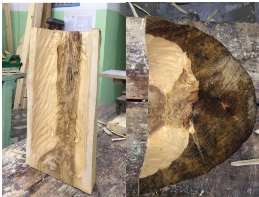
7-сурет. Құрастырылмалы ағаш шелек үшін ағаш діңінің ойылған бөліктері [Fig. 7. Carved trees for a composite wooden bucket]
